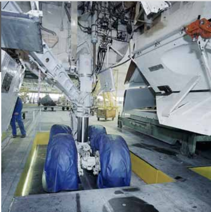
升降平台用于检查起落装置
